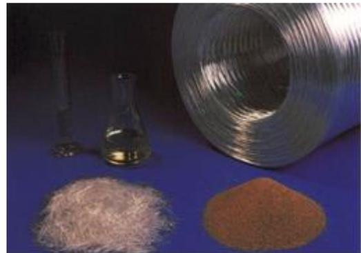
**Figure 3** : Matières premières utilisées pour la fabrication de PRV.
